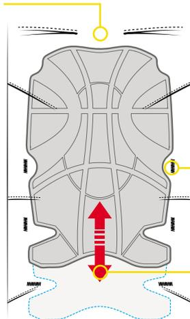
Sechs Riegel fixieren den Knieschoner, zwei in der Höhe und vier für einen optimalen, mittigen Sitz.
